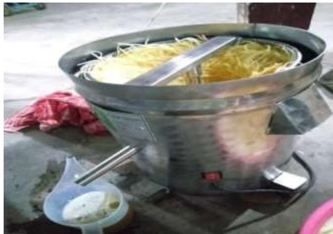
Gambar 3. Proses diskiner pemisahan buah dengan minyak
